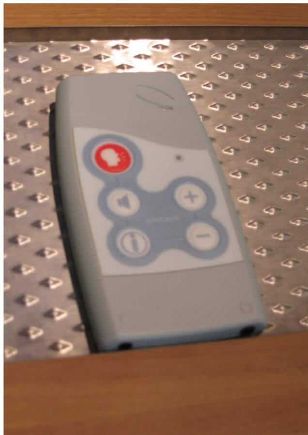
*Illustration 8: Boîtier expérimenté à la gare Montparnasse, compatible avec le système EO guidage.*
