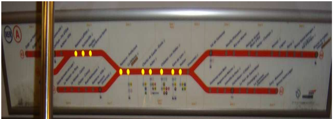
Photo 1 : Voyants lumineux à l'intérieur des rames indiquant les gares desservies
